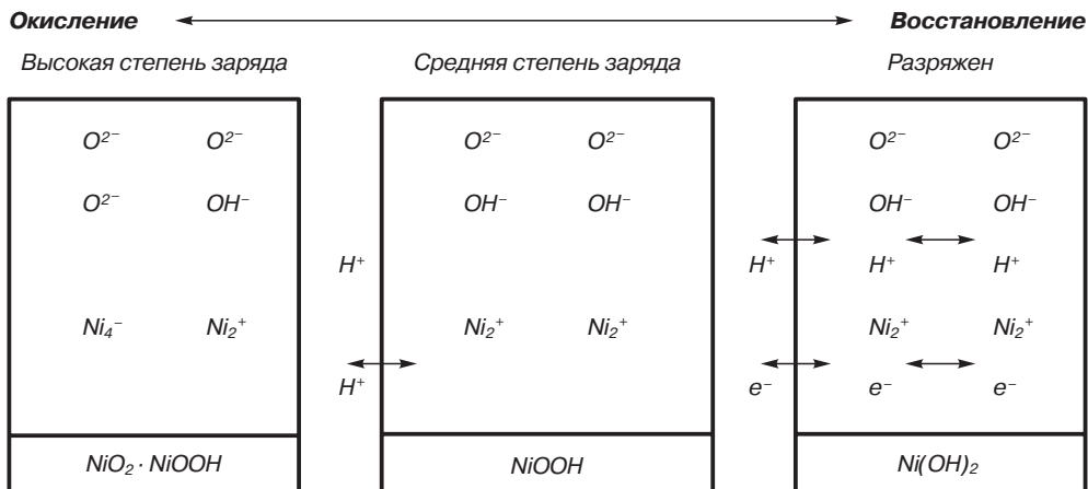
Рис. 2. Механизм электрохимических реакций никельгидридного аккумулятора
